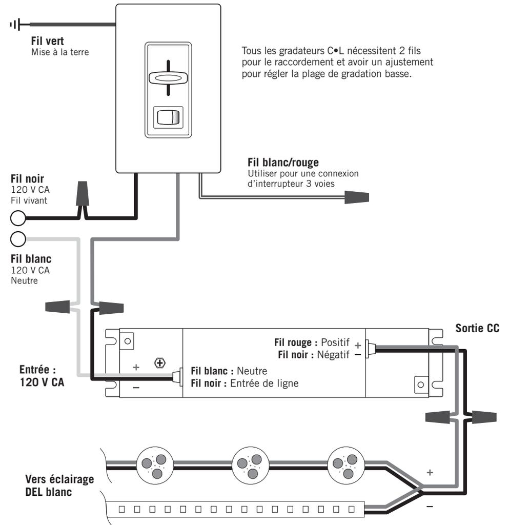
Le bloc d'alimentation est prévu pour une connexion directe seulement. Inclut un boîtier de métal homologué NEMA 1. Après avoir retiré les alvéoles défonçables, installer des serre-câbles et faire passer les fils de façon à correspondre à l'emplacement d'installation.
